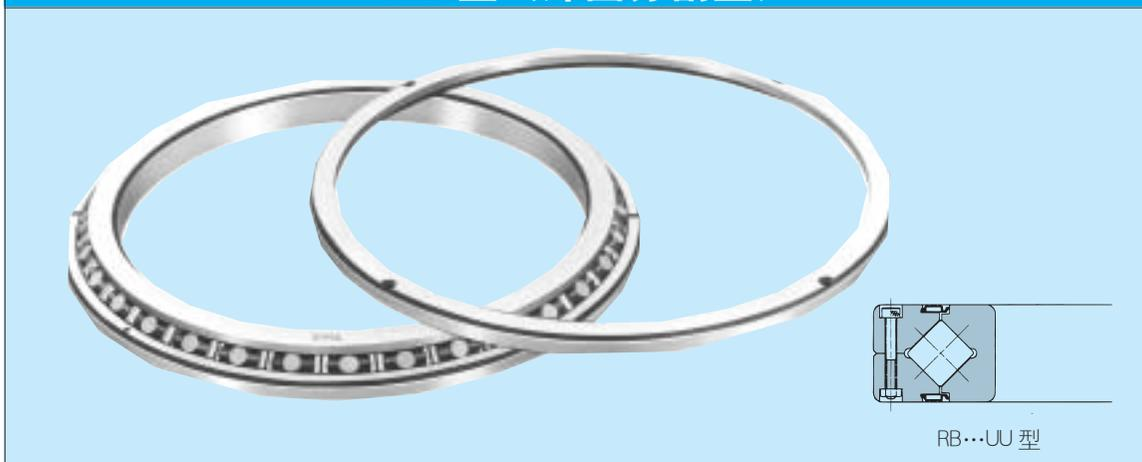
RB 型的內外圈尺寸被最小限度地小型化，其構造為外圈是2分割，內圈是一體的設計。最適合於要求內圈旋轉精度高的地方。
