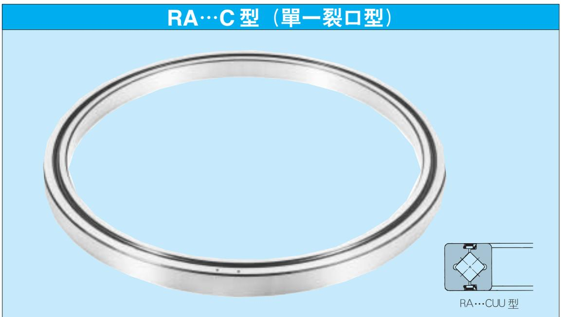
RA...C 型的主要尺寸與 RA 型相同，因只有外圈的 1 個地方被分裂，是容易安裝且極薄的型式，所以最適合於要求內外圈高剛性・高精度的地方。
