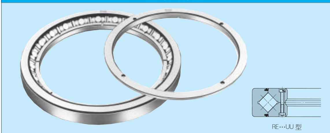
RE 型是由RB型的設計理念產生的新形式，內圈為2分割，外圈為一體構造。最適合於要求外圈旋轉精度高的地方。
