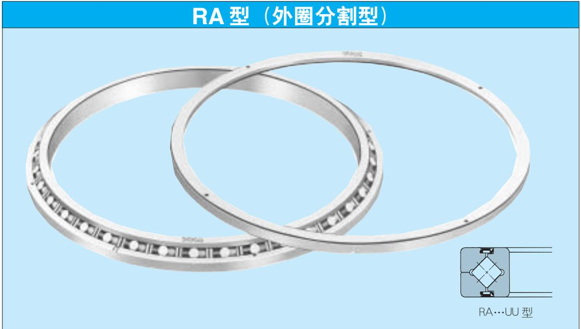
RA型是將內圈和外圈的壁厚做得很薄的小型輕量的交叉滾子軸承。既小型又能承受重負荷，因此軸承座或側面壓緊法蘭盤都可輕量化，最適合於機器人的手部等旋轉關節部分。外圈是2分割的構造，用鉚釘固定後成為非分開型式。
